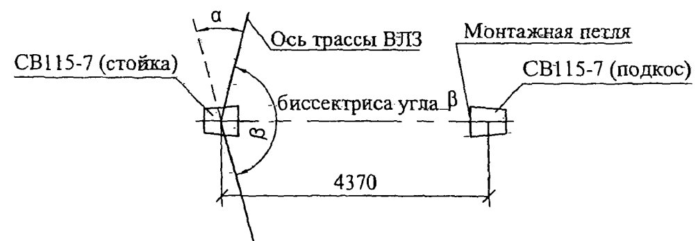
Схема установки стойки и подкоса
