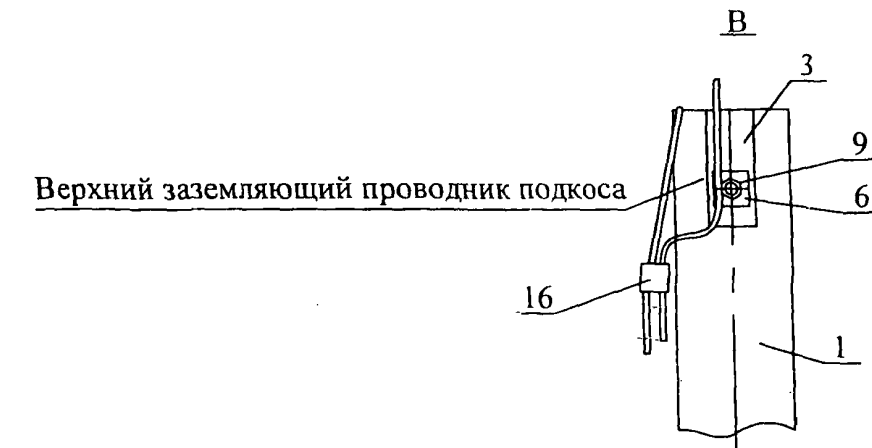
Схема 1 установки на ВЛЗ А10-11 в качестве анкерной опоры
